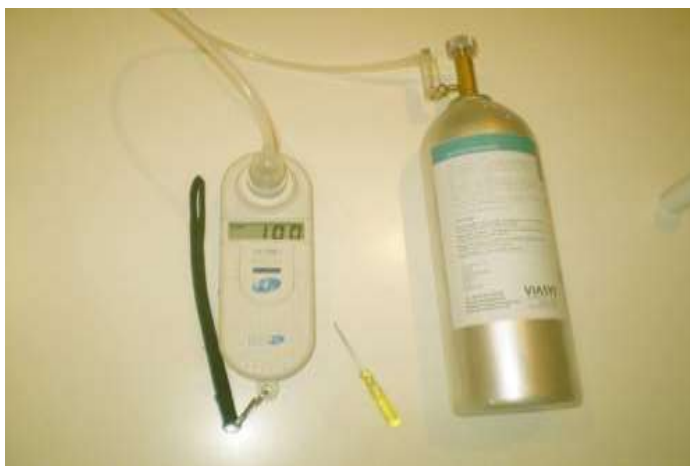
Рисунок 6 — Портативный электрохимический анализатор концентрации водорода в воздухе (аппарат только что откалиброван)
