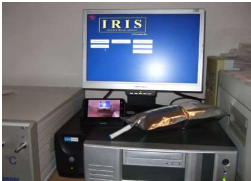
Рисунок 4 — Общий вид системы IRIS для проведения ^{13}\text{C} -дыхательных тестов
