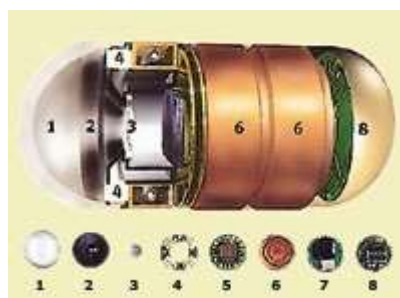
Рисунок 2 — Внешний вид и строение видеокапсулы М2
